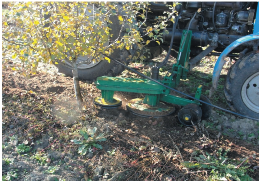
Рис. 2. Загальний вигляд фрези в роботі
